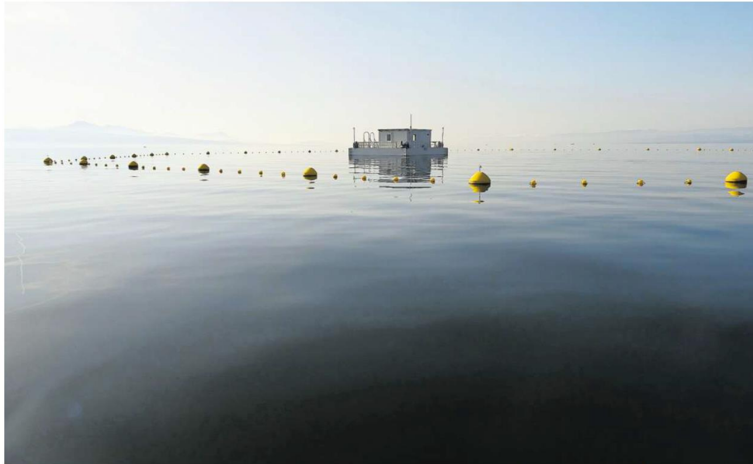
Die Forschungsplattform Lexplore ist 570 Meter vor dem Ufer von Pully verankert, 28 Solarpaneele versorgen sie mit Strom. Die Forscher können ihre Wasserproben direkt auf der Plattform auswerten, im Innern des Arbeitscontainers ist auch ein kleines Labor eingerichtet.
